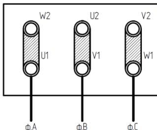
Подключение по схеме «треугольник»
