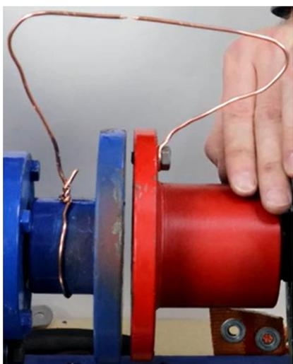
Загните провода так, как показано на фото. Выровняйте провода максимально точно. Зазор между ними должен быть минимальным.
